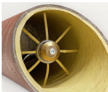
Das Sprüschleuderverfahren „Tubus System“ ist für gängige Rohrwerkstoffe einsetzbar und saniert Rohrdimensionen von DN 50 bis 250. | Foto: Tubus System
